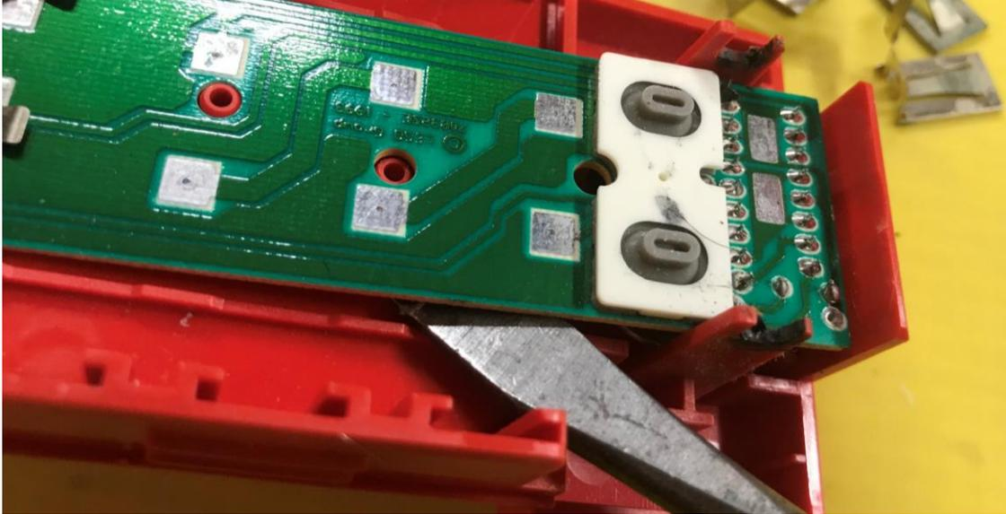
19. Wenn sich die Platine löst, diese möglichst nach vorne herausziehen, um die Kontakte zum Motor nicht zu verbiegen.
