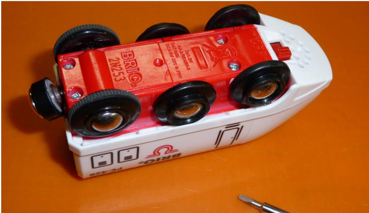
Den passenden Innendreikantschraubendreher (auch Dreiecksschraubenzieher oder Triangle Driver genannt) hat nicht jeder im Werkzeugkasten und im Baumarkt findet man den üblicherweise auch nicht. Passende Schraubendreher oder Bits gibt es in Handy-Reparatur-Sets, allerdings oft in sehr unterschiedlichen Größen. Brauchbar sind Größen zwischen 1,8 und 2,3 mm Dreieckslänge (2.0 oder 2.3).
