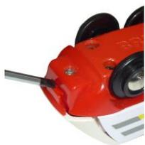
Für die Fernbedienung braucht man zwei AA-Batterien. Der Einsatz von Akkus lohnt sich hier eher nicht, weil die Selbstentladung der Akkus höher ist als der Stromverbrauch (Ausnahme: Eneloop-Akkus mit geringer Selbstentladung). An der Fernbedienung die Schraube an der Unterseite lösen und den Deckel mit einem Fingernagel oder Schraubenzieher öffnen. Nach dem Einlegen der Batterien den Deckel wieder fest verschrauben.
