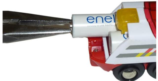
Beim Batteriewechsel sind eingelegte Batterien oft schwer zu greifen. Auf keinen Fall versuchen, die Batterie herauszuschütteln oder zu schlagen. Dabei besteht die Gefahr, dass die Kabel im Gelenk zwischen den beiden Lok-Teilen brechen. Besonders Akkus sind manchmal geringfügig dicker als normale Batterien und sitzen fester. Diese mit einer Flachzange herausziehen. So hält man Schäden von Lok und Batterien fern.
