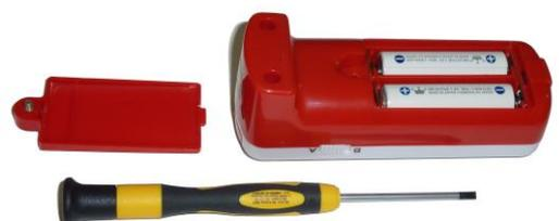
Bei fehlender Funktion die Batterien einzeln mit einem Batterietester prüfen, insbesondere bei gebrauchten Batterien oder Akkus, da deren Ladezustand sehr unterschiedlich sein kann. Hier möglichst solche auswählen, die in etwa gleich geladen sind. Batterien und Akkus nicht mischen, auch nicht gleiche Akkus oder Batterien, die unterschiedlich geladen sind. Da handelsübliche Akkus nur über 1,2 Volt verfügen, sind diese schneller leer als Batterien, können aber wieder aufgeladen werden.
